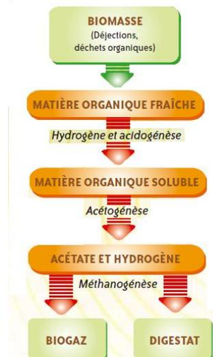
Figure 1 : Réactions du processus de méthanisation
