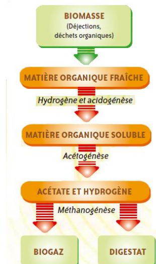
Figure 1 : Réactions du processus de méthanisation
