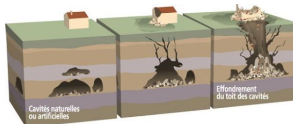
Figure 32 : Le risque d'effondrement des cavités
