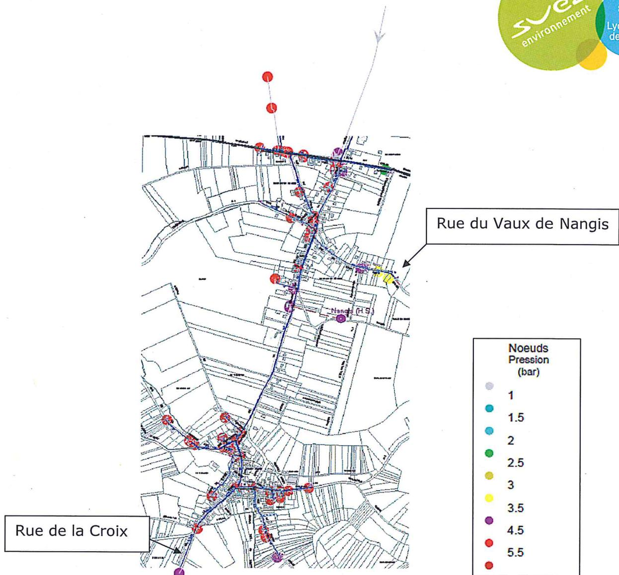
La carte ci-dessus met en évidence la rue du Vaux de Nangis (notamment en extrémité de l'antenne) où la pression calculée est la plus faible sur l'ensemble de la commune (pression statique de l'ordre de 2,5 bars).
