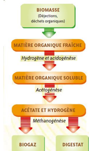
Figure 1 : Réactions du processus de méthanisation
